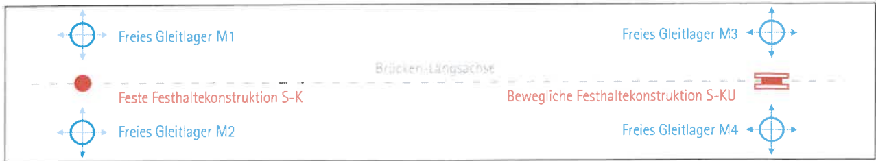
Festhaltekonstruktion - typischer Aufbau mit Bauwerkslagern
